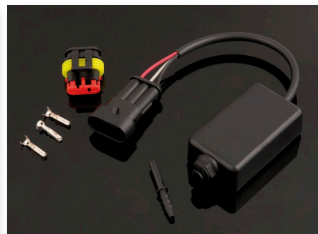
Fig 3.3c - Extern MAP-sensor kan även den monteras direkt in i adapterhärvan. För t.ex. mätning av avgasmottryck eller för de som tycker 3bars laddtryck med den interna MAP-sensorn inte räcker...
